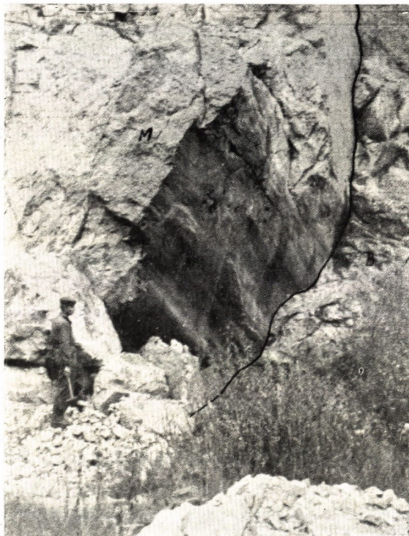
O b r. 3: Podložné tektonické ukončenie ložiska Amág lomu.. M — magnezit, B — grafit. bridlica s lavicovitým dolomitom.
